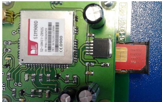
Фото 16.1. Установка лотка на место
